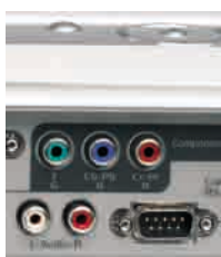
A komponens bemenetek a HD jelek fogadását is támogatják
