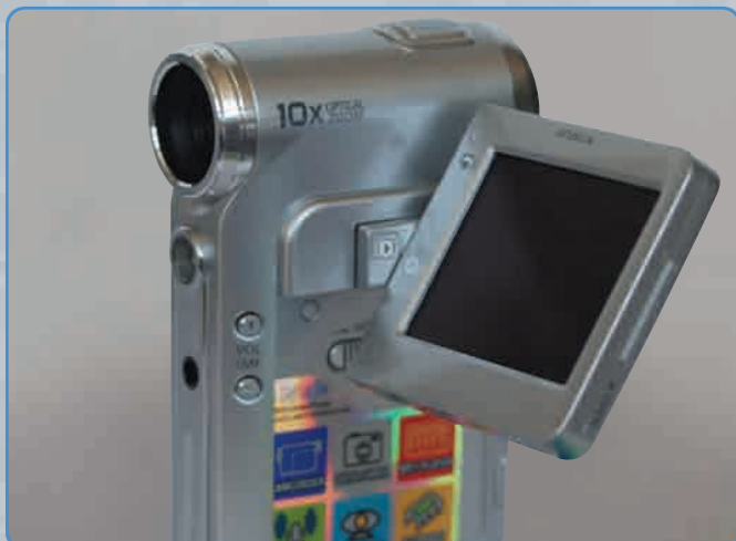
Az M110 LCD kijelzője mindössze 5,1 cm-es átlójú, azonban felbontása nagyon jó. A kijelző felőli oldalon, elől kapott helyet az a többfunkciós kezelőgomb-pár, amellyel felvételi üzemmódban a manuális fókusz, míg lejátszáskor a beépített hangszóró hangerőszintjét szabályozhatjuk.
