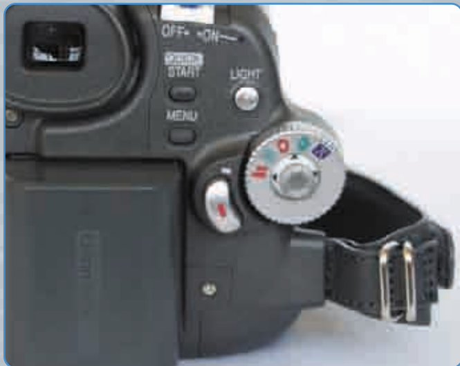
A menük paramétereinek beállításainál nagyon nagy segítséget jelent a készüléken kitűnően elhelyezett üzemmódválasztó tárcsa/joystick kezelőszerv-megoldás, amely rendkívül gyors navigációt tesz lehetővé.
