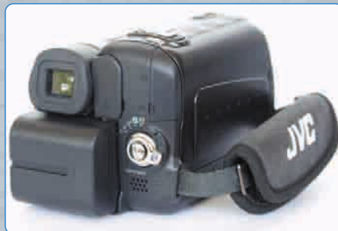
...csakúgy mint a készülékház tetejének hátsó részén kialakított zoom „csúszka” és a snapshot/slow nyomógomb, amelyeket a mutatóujjunkkal kezelhetünk könnyedén
