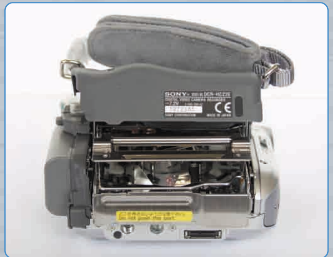
A Mini DV kazettát befogadó kazettafészek nyílását a HC22E alsó részén alakították ki. A kinyitott mechanizmus alatt jobbra alul látható a csatlakozóport, amely a kamera és a dokkolóegység összekapcsolását szolgálja.
