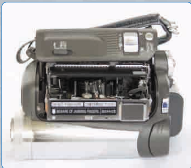
A Mini DV kazettát felülről helyezhetjük a kamerába, míg az SD kártyák fogadására szolgáló memóriakártya nyíláshoz az LCD kijelzőt kihajtva férhetünk hozzá.
