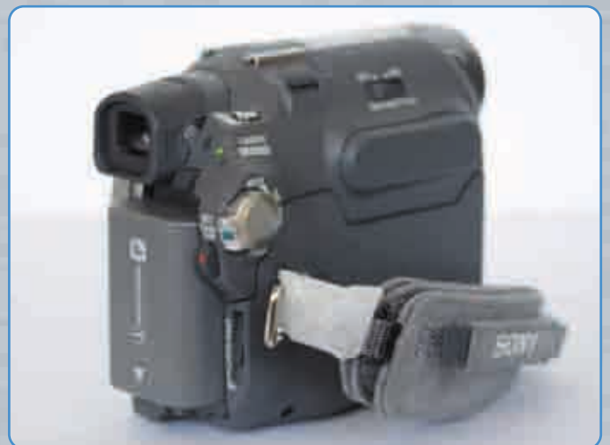
A készülék háza tetejének jobb oldali részén látható a zoom „billenőkar”, mögötte pedig kissé lejjebb, az állóképek exponálásához használatos „Photo” nyomógombnak alakított ki helyet. A hüvelykujjunk környezetében található a készülék be- illetve kikapcsolására, valamint a kamera, vagy a lejátszás/szerkesztés funkciók aktiválására szolgáló forgókapcsoló. Ugyanezen a területen helyezkedik el a felvétel indító és leállító nyomógomb, amely másik változatában az LCD kijelző keretén is megtalálható.
