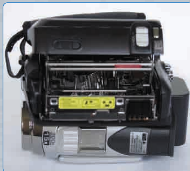
A Mini DV kazettát felülől tölthetjük be a kamkorderbe, míg a gondosan lezárt memóriakártya nyílás a készülék aljának hátsó részén található.
