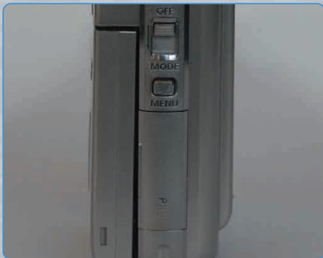
A Memory Stick, vagy Memory Stick PRO memóriakártyák fogadására alkalmas nyílás a kamera hátlapjának alsó részén, egy lezárható ajtócska mögött található.
