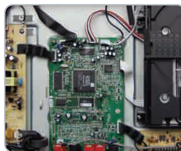
A készülék belsejének közepén, előkelő helyen láthatjuk az ESS Vibrato II processzort
