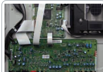
Szépen kialakított készülékbelső rengeteg SMD alkatrészsel, köztük a MediaTek MT1389EE processzorával
