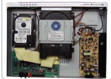
Íme a 80GB-os HDD egység és az alsó nyomtatott áramköri kártyán a Sigma Designs, Inc. EM8500 média processzor.
