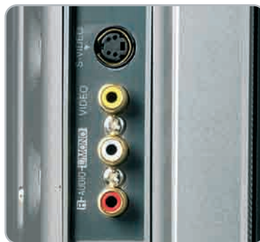
A kompozit és S-Video csatlakozók az elő- és hátlapon is megtalálhatók
