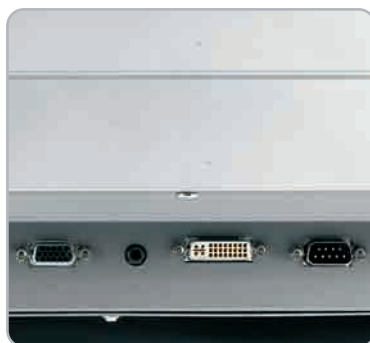
A DVI bemenet a DVI/HDMI rendszerű DVD-lejátszókkal is kompatibilis
