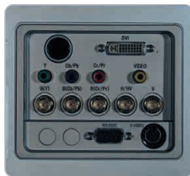
RGB fogadására is alkalmas komponens, valamint a digitális források számára DVI bemenet is rendelkezésre áll
