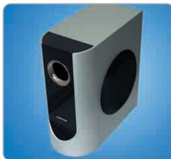
Az ezüstsínű dobozház elején egy fekete műanyag betét hangsúlyozza ki a bass-reflex port krómzott felületet imitáló nyílását. A mélyhangszóró a kabinet jobb oldalán, a fixen rögzített fekete textil előlap mögött rejtőzködik.
