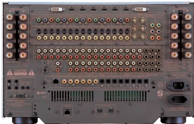
13 AV bemenet áll rendelkezésre, melyek mindegyike felkonvertálható HDMI-re. Ezenkívül két többszörös csatornás bemenetet is kapunk, melyek SACD és Blu-ray hanganyagokkal is használhatók.
